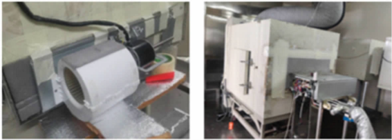
(a) 风机 (b) 风机盘管 图 6 风机和风机盘管气动性能测试装置
